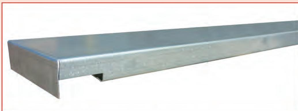
Nel caso serva un piano di appoggio pieno (Es: picking manuale, bancali fuori standard etc..) E' possibile installare pianetti a cavallotto che con la loro forma particolare supportano pesi notevoli abbracciando la trave in modo adeguato. Disponibili in spessore 12 o 15/10.
