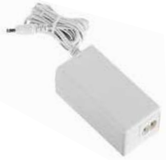
6690-50-006 Alimentatore per sottopensili 36W 24V con cavo da 1,5 + 1,5 mt. 36W 24V underwall unit power supply with cable 1,5 + 1,5 mt. Alimentation pour règlette sous meuble 36W 24V avec le cable de 1,50 + 1,50 mt. 36W 24V Trafo für Unterbauleuchte mit Kabel 1,5+ 1,5 mt.
